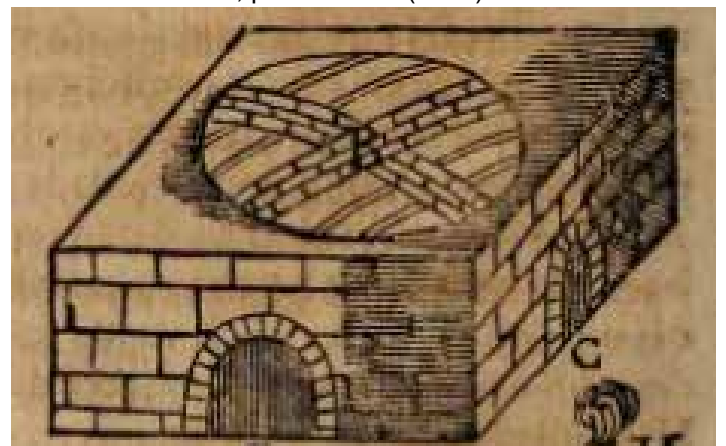
Figura 2. Suelo de horno de tostadillo. Recuperado el Arte de los Metales, por A. Barba (1640).
