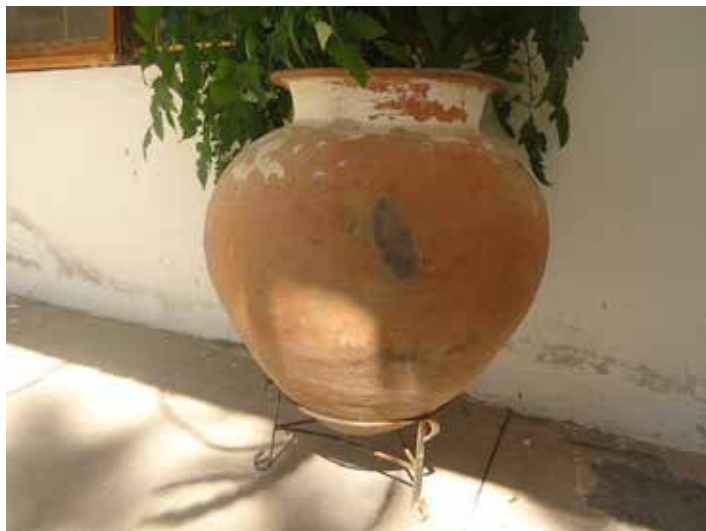
Figura 5. Cántaro de trabajo para el proceso de ignición de la salmuera. Registro fotográfico por R. A. León Hernández, 2014, San Felipe Ixtapa, Oaxaca.
